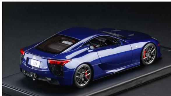
トヨタ自動車の「LFA 工房」にて、ほぼ全行程を職人によるハンドメイドにより量産された国産スーパーカーがこの LFA です。570 馬力を発生する V 型 10 気筒エンジンを搭載し日本国内で約 200 台、全世界では約 500 台が販売されたといわれています。
